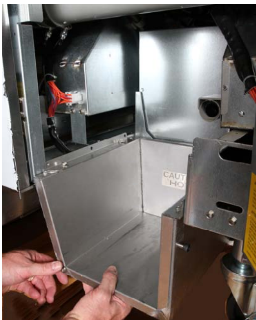
Figuur 2: Plaats de smeltende unit.
