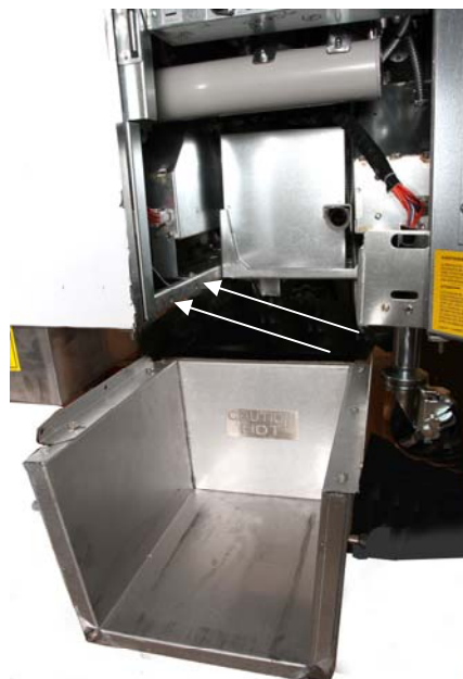
Figuur 1: Plaats de smeltende unit in de kast en bevestig met de meegeleverde schroeven aan de kast.
